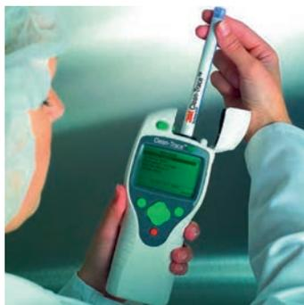
Luminómetro para detección en pruebas de ATP
