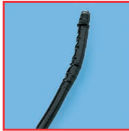
Hinchamiento de un tubo de alimentación utilizando un producto de cuidado inapropiado.
