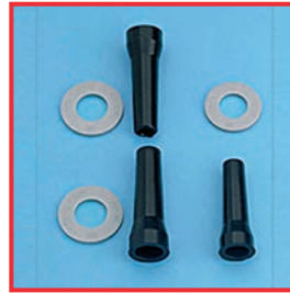
Derecha: Juntas hinchadas como consecuencia de la aplicación incorrecta (no selectiva) de aceite para instrumentos. Izquierda: Nuevas juntas
