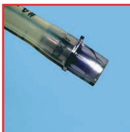
Grieta por tensión
