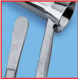
Manchas provocadas por una cantidad elevada de sales en el agua de aclarado
