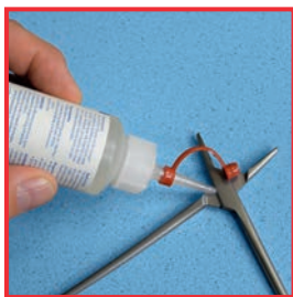
Mantenimiento específico de la articulación
