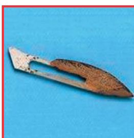
Daños en la superficie de la hoja provocados por la humedad. Causa: Composición del material, acero normal producto desechable.
