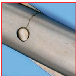
Grietas de tensión en la zona de unión de unas tijeras.
