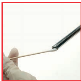
Limpieza del objetivo de un endoscopio
