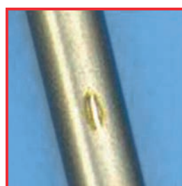
Corrosión de contacto: Acero inoxidable/Acero inoxidable
